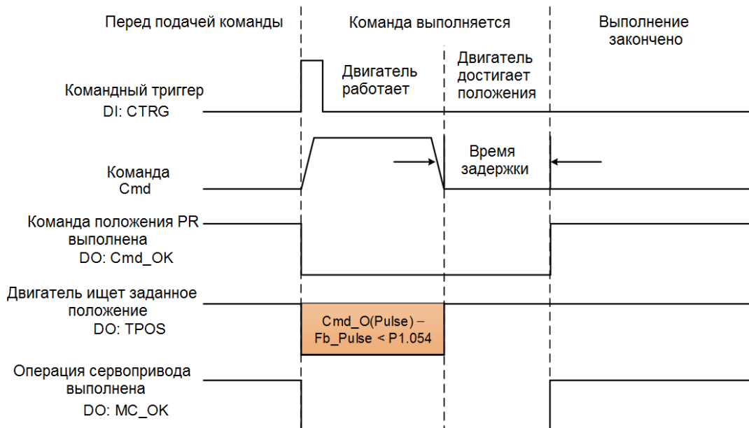
Рис. 7.1.2.4 Работа сигналов на DI/DO в режиме PR (включая время задержки)
