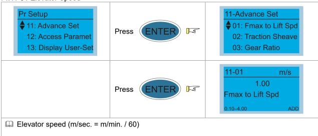
Pr.11-02 Traction Sheave Diameter
