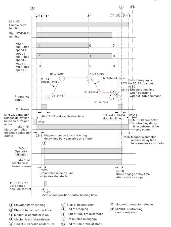
**Elevator Timing Diagram**
