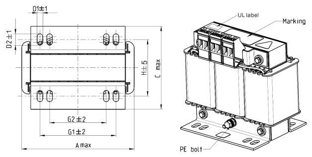
Tightening torque: 0.6-0.8 Nm
